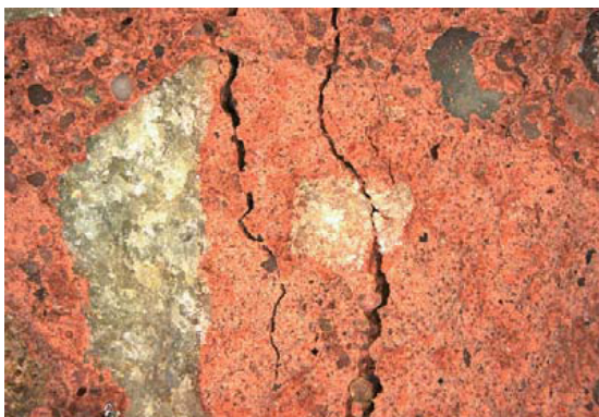
BETOCRETE-C17 (BV) in eingefärbtem Beton vor Wasserlagerung (Schnittfläche 16-fach vergrößert)
