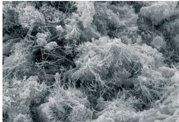
Mit BETOCRETE-C17 (BV) modifizierter Beton wird durch die entstandenen „Fasern“ abgedichtet.
